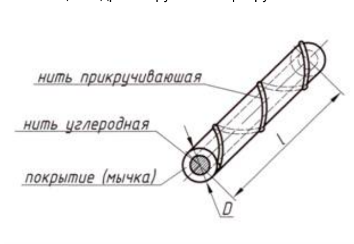
Рисунок 2 - Схема комбинированной углеродной нити
