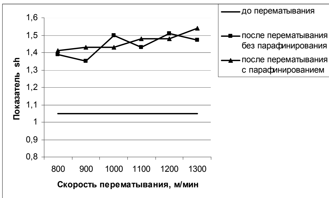
Рисунок 2 – Показатели ворсистости опытных вариантов гребенной пряжи линейной плотности 18.5 текс до и после перематывания
