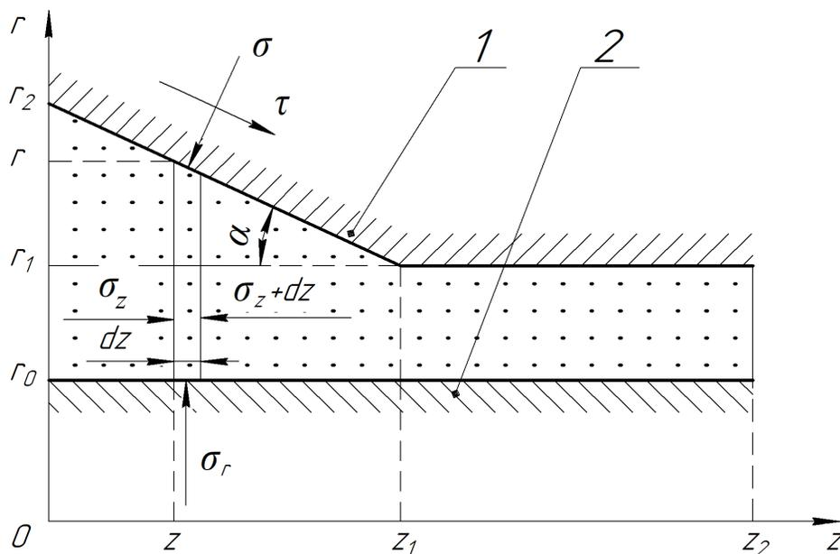
Рисунок 1 – Схема зоны деформации: 1 – поверхность матрицы, 2 – поверхность дорна
