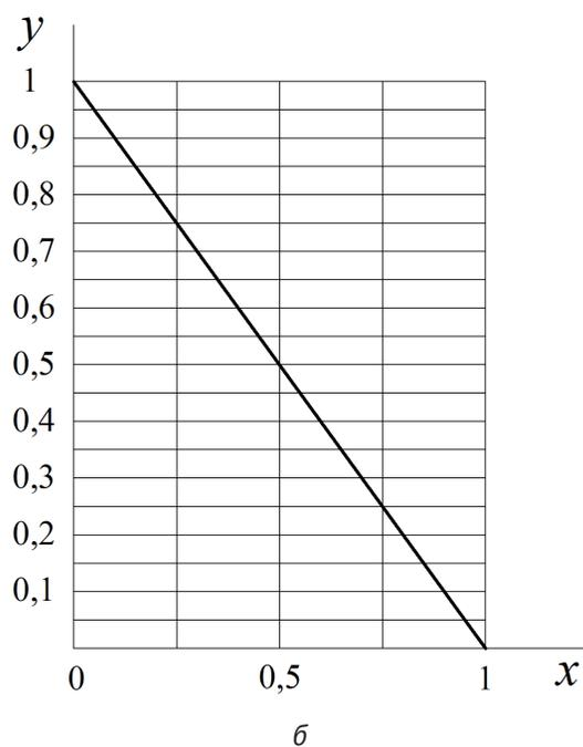
Рисунок 3 – Распределение касательных напряжений  $\tau = f(y) = \text{const}$  (а) и соответствующий ему треугольный профиль канала  $x = f(y)$  (б)
