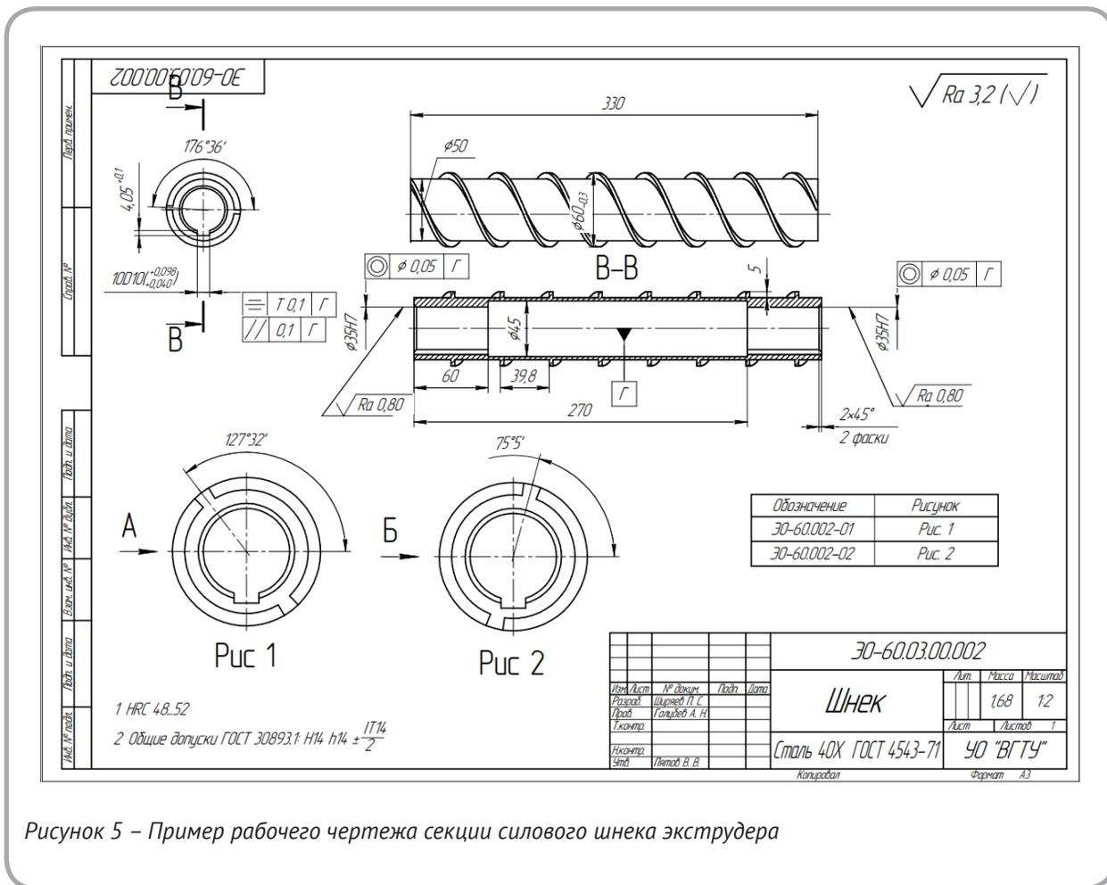
Рисунок 5 – Пример рабочего чертежа секции силового шнека экструдера
