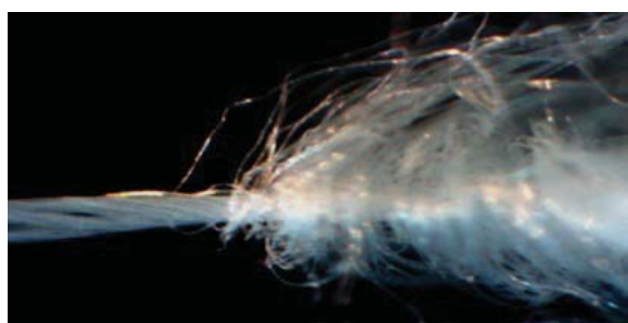
Рисунок 1 – Микроскопический снимок армированной полиэфирной нити
