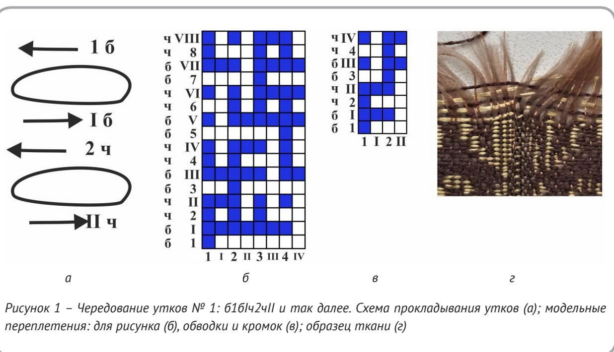
Рисунок 1 – Чередование утков № 1: 61б|42чII и так далее. Схема прокладывания утков (а); модельные переплетения: для рисунка (б), обводки и кромок (в); образец ткани (г)
