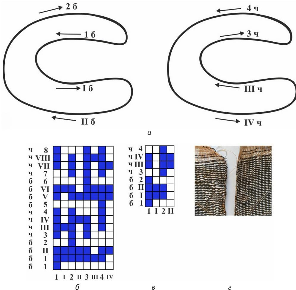
Рисунок 6 – Чередование утков № 6: 61б|61|62ч3ч||ч|ч|ч4 и так далее. Схема прокладывания утков (а); модельные переплетения: для рисунка (б), обводки и кромок (в); образец ткани (г)
