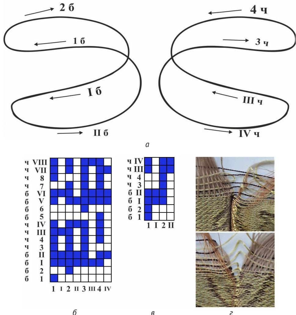
Рисунок 5 – Чередование утков № 5: 61626|6||43444|4|IV и так далее. Схема прокладывания утков (а); модельные переплетения: для рисунка (б), обводки и кромок (в); образец ткани (г)
