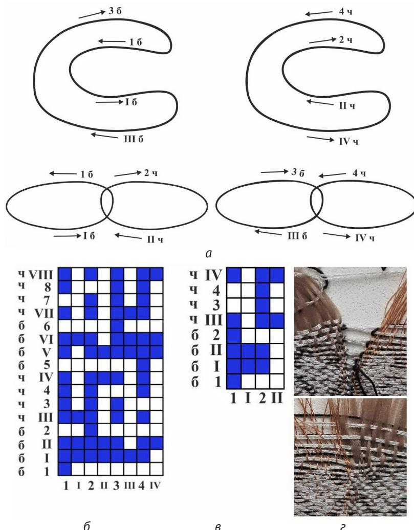
Рисунок 4 – Чередование утков № 4: б1б|бII|б2ч||ч3ч4ч|V и так далее. Схема прокладывания утков (а); модельные переплетения: для рисунка (б), обводки и кромок (в); образец ткани (г)
