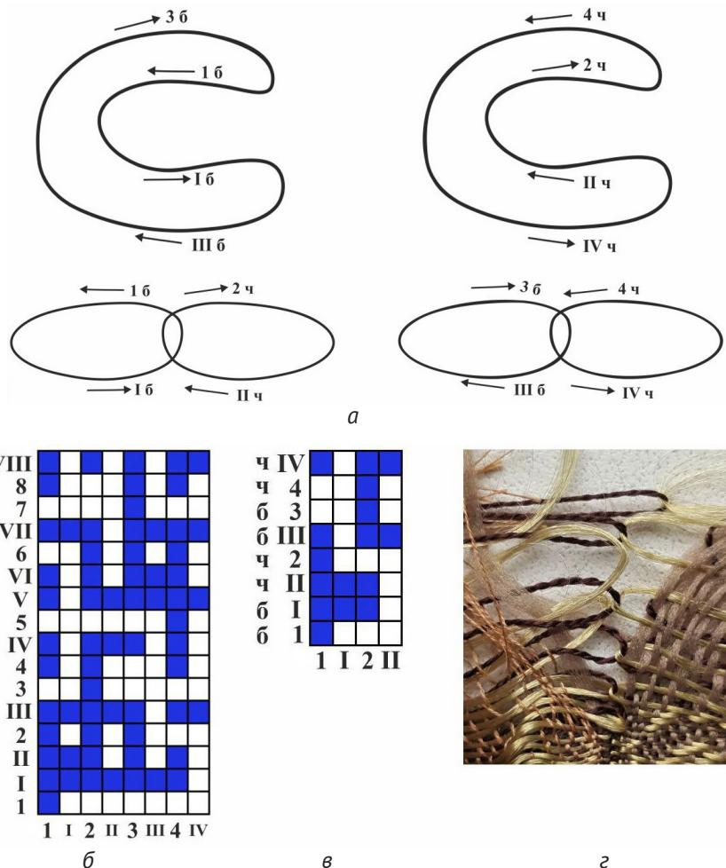
Рисунок 3 – Чередование утков № 3: б1б/чIIч2бII/б3ч4чIV и так далее. Схема прокладывания утков (а); модельные переплетения: для рисунка (б), обводки и кромок (в); образец ткани (г)
