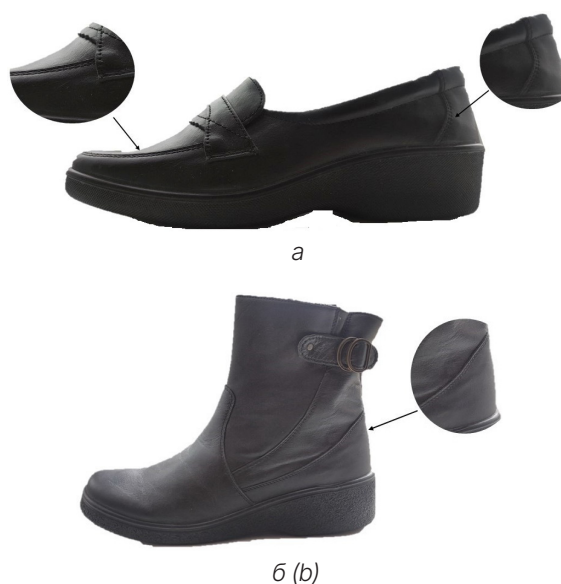
Рисунок 1 – Примеры конструкции обуви, из которых невозможно выкроить образцы для испытания по ГОСТ 9290-76
