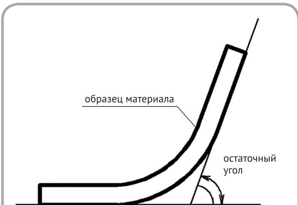
Рисунок 1 – Определение остаточного угла образца материала
