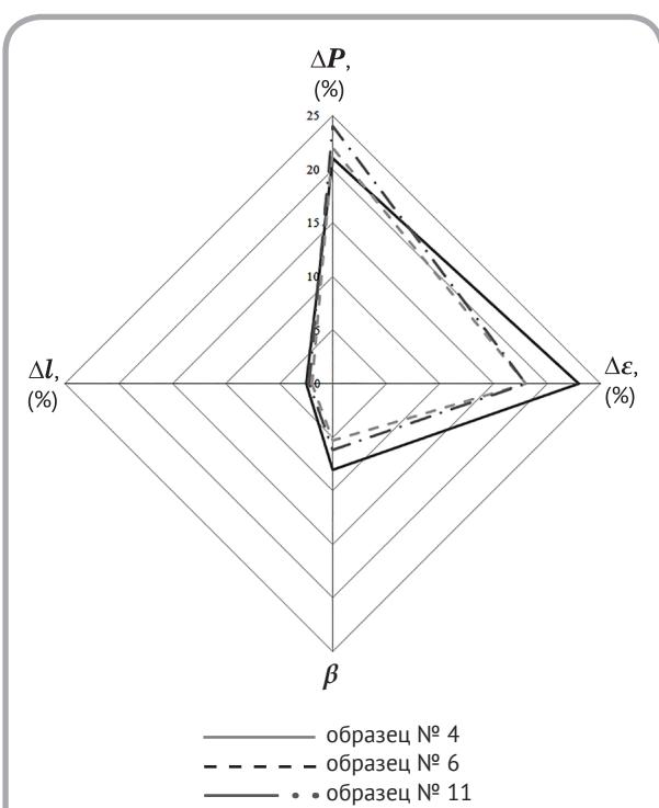
Рисунок 4 – Изменение качества образцов материала после 20000 циклов многократного изгиба
