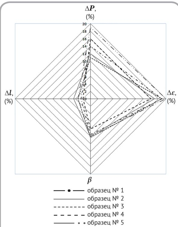
Рисунок 3 – Изменение качества образцов материала после 20000 циклов многократного изгиба
