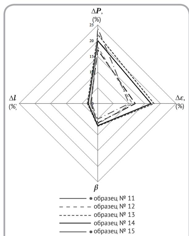
Рисунок 6 – Изменение качества образцов материала после 20000 циклов многократного изгиба
