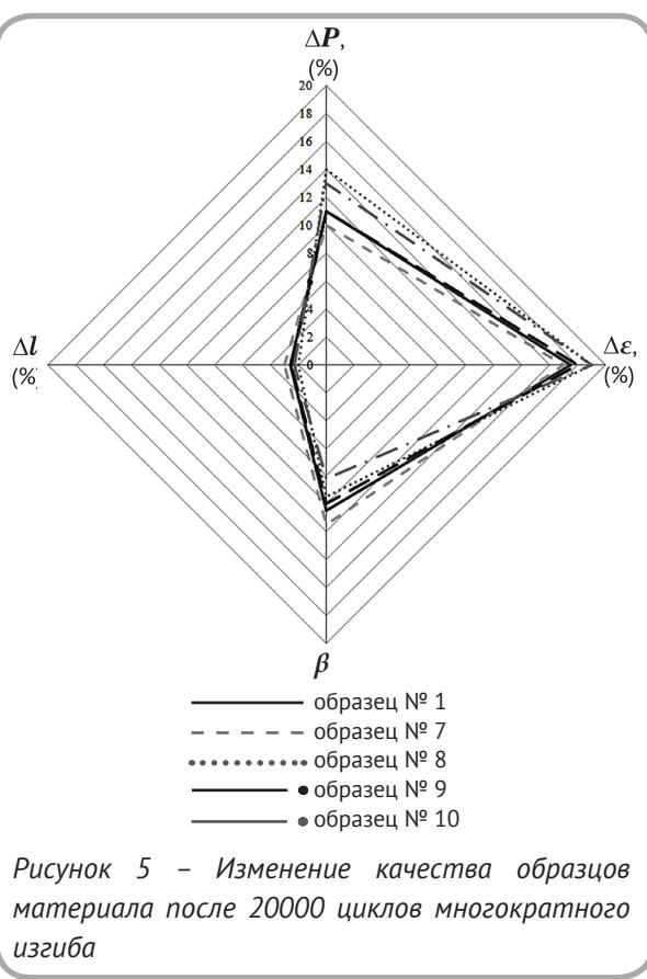
Рисунок 5 – Изменение качества образцов материала после 20000 циклов многократного изгиба
