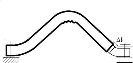
Рисунок 2 – Определение сокращения длины образца материала ( $\Delta l$ )
